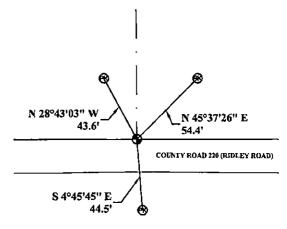
BASIS OF BEARING **GPS GRID BEARINGS** GROUND DISTANCES
